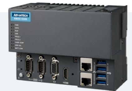
L'AMAX-5580, par exemple, est un contrôleur IPC avec EtherCAT Slice I/O fréquemment utilisé dans les ateliers d'usine en raison de sa conception durable et sans ventilateur adossée à des capacités en temps réel. Il renferme un processeur Intel® Core™ i7/i5 / Celeron®.
