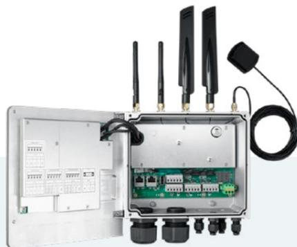
Le tout dernier UNO-430 d'Advantech est un véritable ordinateur industriel conçu pour des utilisations en périphérie de réseau. De petites dimensions, il est étanche à l'eau et capable de résister aux températures extrêmes (chaud et froid) des applications industrielles.
